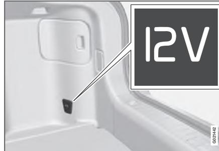
Для доступа к электрическому гнезду откиньте крышку. Гнездо работает независимо того, включено зажигание или нет. Используйте электрическое гнездо при работающем двигателе, чтобы избежать разрядки аккумуляторной батареи.
