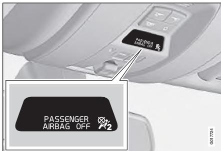
Индикация в потолочной консоли, которая указывает, что подушка безопасности (SRS) на стороне пассажира отключена.
