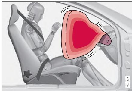
В дополнение к ремню безопасности автомобиль на стороне пассажира оснащен надувной подушкой безопасности, которая сложена в пространстве над отделением для перчаток, на панели которого имеется маркировка **SRS AIRBAG**.
