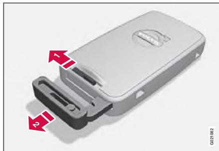
Потяните в сторону подпружиненную защелку **1** и одновременно вытяните плоский ключ назад **2**.
