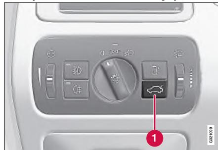
Чтобы отпереть крышку багажника, нажмите кнопку **1** на панели освещения.
