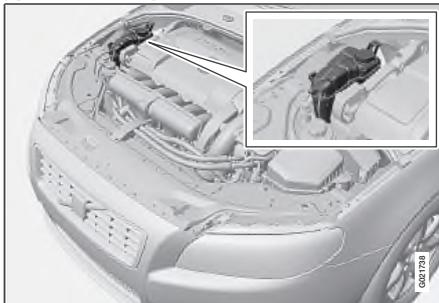
При заправке выполняйте инструкции, приведенные на упаковке. Для оптимизации морозоустойчивых и антикоррозийных свойств следите за тем, чтобы всегда добавлять в охлаждающую жидкость смесь, состоящую из 50 % воды и 50 % охлаждающей жидкости. Никогда не добавляйте только чистую воду. Стойкость к замерзанию снижается, как при недостаточном, так и избыточном
