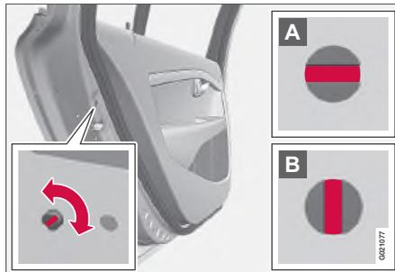
Регулятор замка для безопасности детей находится на задней кромке задних дверей, и доступ к нему возможен только при открытой двери.
