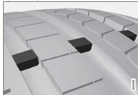
Индикатор износа протектора представляет собой узкий выступ, расположенный поперек дорожки протектора. На боковине шины находится маркировка **TWI** (Tread Wear Indicator).
