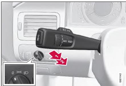
Ручка регулировки света и подрулевой рычаг
