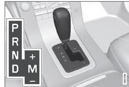
На информационном дисплее с помощью следующих символов отображается положение селектора передач: P, R, N, D, S, 1, 2, 3, 4, 5 или 6. См. стр. 60.
