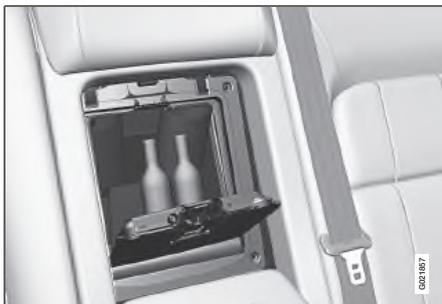
Расположен за подлокотником заднего сидения, емкость 11,5 литров. Холодильник работает всегда, когда двигатель работает или зажигание находится в положении II, и отключается, когда двигатель останавливается.
