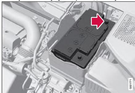
2. Задвиньте аккумулятор внутрь и в сторону до заднего края подставки.
