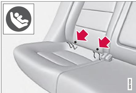
Точки крепления системы ISOFIX скрытаны сзади в нижней части спинки внешних мест заднего сидения.
