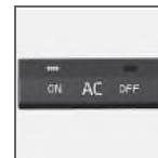
Если горит лампа **ON**, кондиционирование воздуха работает в автоматическом режиме. В этом случае поступающий воздух умеренно охлаждается и подсушивается. Если горит лампа **OFF**, кондиционирование воздуха всегда отключено. Прочие функции управляются по-прежнему в автоматическом режиме. При выборе дефростера кондиционирование происходит с максимальным осушением воздуха.
