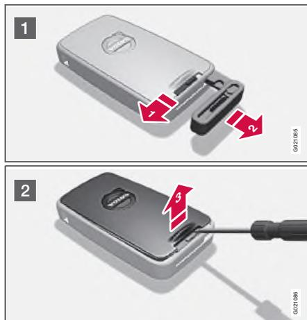
Тип батареек: CR2430, 3 В (одна в дистанционном ключе и две в РСС).
