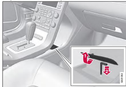
Если автомобиль находится в нерабочем состоянии, например, разряжена аккумуляторная батарея, то для перемещения автомобиля необходимо вывести рычаг переключения передач из положения **P**.
