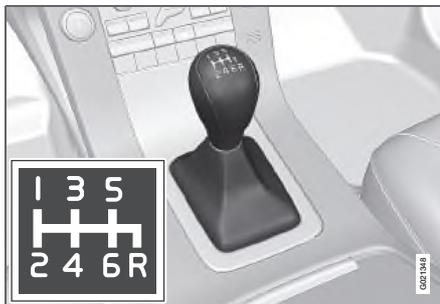
Полностью выжимайте педаль сцепления при каждом переключении передачи. Снимайте ногу с педали сцепления между переключениями передач. Следуйте указанной схеме переключения передач.
