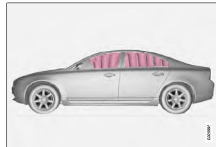
Надувной занавес IC (Inflatable Curtain) является дополнением к подушкам SIPS и SRS. Он смонтирован в облицовке потолка вдоль боковин автомобиля и защищает все внешние места в автомобиле. При достаточно сильном столкновении датчики реагируют, и занавес надувается. Надувной занавес помогает во время столкновения защитить голову водителя и пассажиров от ударов о внутренние поверхности автомобиля.
