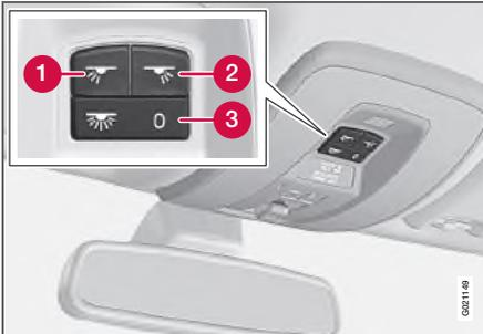
Клавиши регулировки ламп для чтения и потолочного освещения впереди
