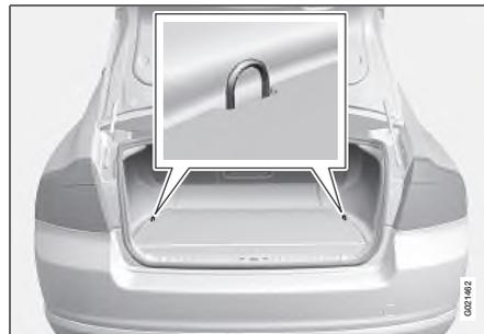
Откидные проушины для крепления груза используются для фиксации стяжных лент, закрепляющих предметы в багажном отделении.
