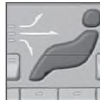
Фигура образована тремя клавишами. При нажатии на клавишу загорается лампа, соответствующая определенной части фигуры, указывая, какой тип распределения воздуха выбран, см. стр. 113.
