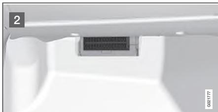
Отогните внутреннюю обивку, закрывающую блок предохранителей.
