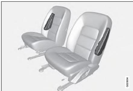
SIPS (Side Impact Protection System) направляет большую часть силы удара на балки, стойки, пол, крышу и другие элементы кузова автомобиля. Боковые подушки безопасности на стороне водителя и пассажира защищают грудь и бедра и являются важным элементом системы SIPS. Система подушек SIPS состоит из двух основных частей: боковой подушки безопасности и датчиков. Боковая подушка безопасности смонтирована на раме спинки переднего сидения.
