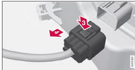
Все лампы впереди (за исключением противотуманных) можно заменить из двигательного отсека, отсоединив и вынув всю фару в сборе.
