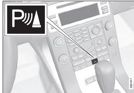
Система включается автоматически при запуске двигателя, и горит лампа в переключателе Вкл/Выкл. Если помощь при парковке отключается кнопкой, то лампа гаснет.
