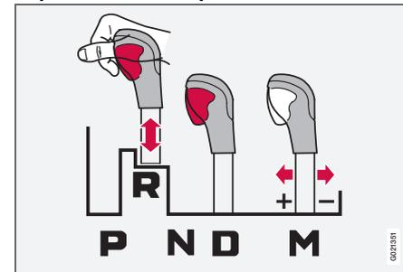
Рычаг можно свободно переводить вперед или назад между **N** и **D**. Остальные положения заблокированы и управляются кнопкой блокировки на селекторе передач.
