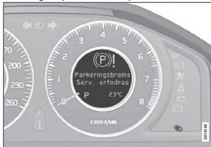
**Стояноч. тормоз не полн. откл. –** Неисправность препятствует освобождению стояночного тормоза. Обратитесь за помощью на официальную станцию техобслуживания Volvo. Если Вы трогаетесь с
