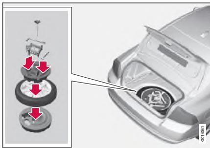
В пенопластовом боксе, расположенном в диске запасного колеса, находятся все инструменты. В инструментарий входит буксировочная скобка, домкрат и баллонный ключ. Пенопластовый бокс закреплен болтом к консоли в днище углубления для запасного колеса.
