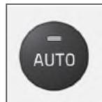
При помощи данной функции регулируется автоматически температура, кондиционирование воздуха, скорость вращения вентилятора,
