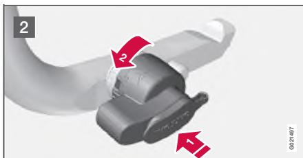
2 Нажмите стопорную ручку и поверните против часовой стрелки до щелчка.
