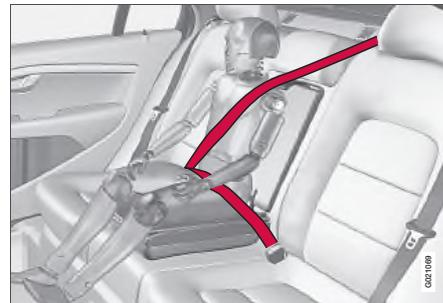
Встроенная фиксируемая ремнем опорная подушка Volvo для среднего места заднего сидения сконструирована специально для обеспечения безопасности детей. В комбинации с обычным ремнем безопасности опорная подушка одобрена для детей весом от 15 до 36 кг. Перед началом поездки проверьте:
