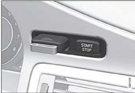
Замок зажигания с дистанционным ключом, кнопка пуска/останова
