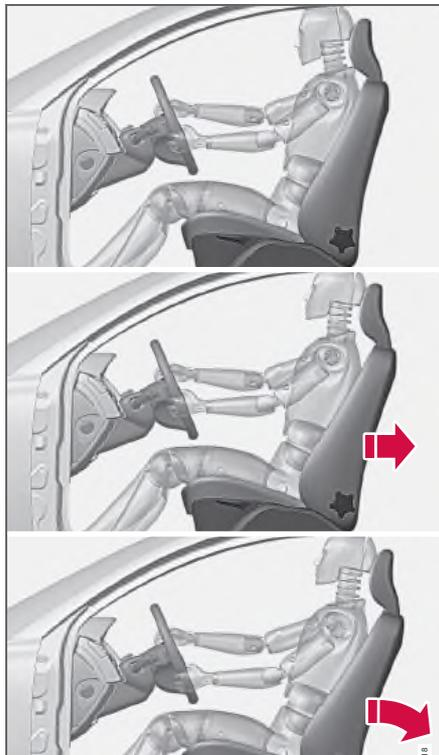
Система WHIPS (Whiplash Protection System) состоит из энергопоглощающей спинки и специально модернизированного для данной системы подголовника в передних сиденьях. Система активируется в момент удара сзади, и ее срабатывание зависит от угла удара, скорости и вида транспортного средства, нанесшего удар.
