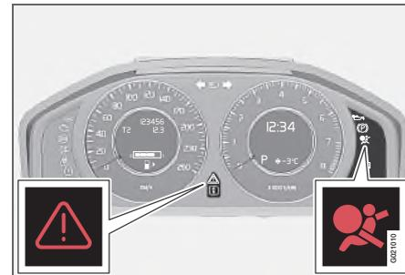
Работа системы Airbag постоянно контролируется модулем управления системы. Предупреждающий символ в комбинированном приборе включается в положении зажигания II или III. Этот символ гаснет прим. через 6 секунд, если система Airbag исправна.
