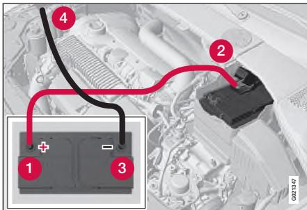
Если аккумуляторная батарея разряжена, автомобиль можно запустить током от другой аккумуляторной батареи.
