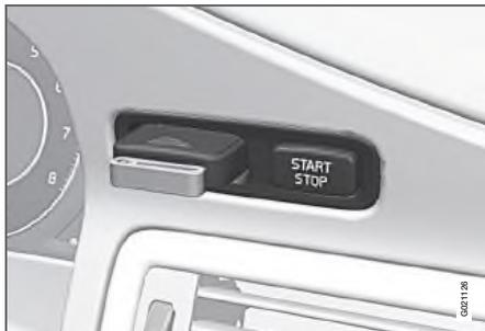
Замок зажигания с дистанционный ключом, кнопка пуска/останова Start/stopp (подробно см. стр. 65).
