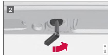
Если на дистанционном ключе не работает кнопка открытия крышки багажника, то ее можно отпереть плоским ключом.
