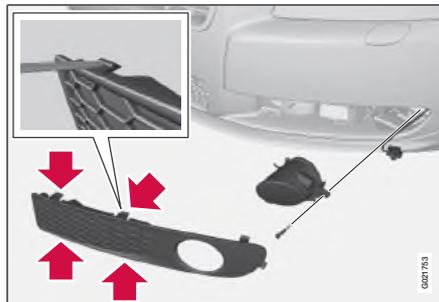
1. Снимите накладку, вдавив зажимы и вытянув наружу накладку.
