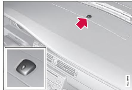
Индикатор в панели инструментов показывает состояние системы сигнализации:
