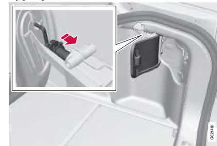
Если крышку топливного бака невозможно открыть из салона, это можно сделать вручную.
