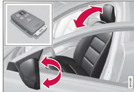
Когда автомобиль отпирается этим же дистанционным ключом и открывается дверь водителя, кресло водителя и внешние зеркала заднего вида
