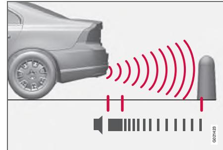
Расстояние, измеряемое по прямой сзади автомобиля, составляет прим. 1,5 м. Звуковой сигнал, указывающий на препятствие позади автомобиля поступает из задних динамиков.
