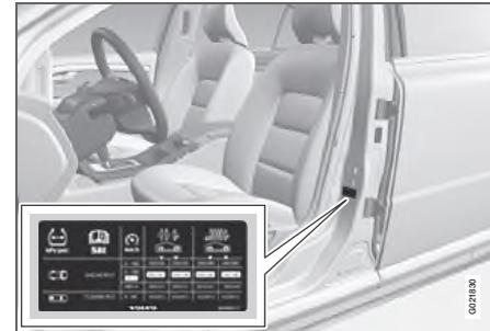
На наклейке, расположенной на дверной стойке на стороне водителя (между передней и задней дверью), указано давление в шинах при различной нагрузке и скоростях. Эта же информация приведена в соответствующей таблице, см. стр. 216.
