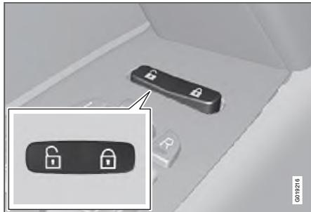
С помощью кнопок в дверной панели можно одновременно запереть или отпереть все двери и крышку багажника.
