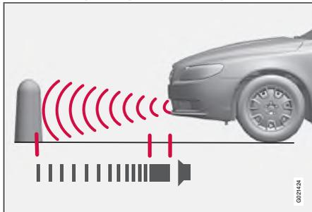
Расстояние, измеряемое по прямой перед автомобилем, составляет прим. 0,8 м. Звуковой сигнал от препятствия перед автомобилем поступает из переднего динамика.
