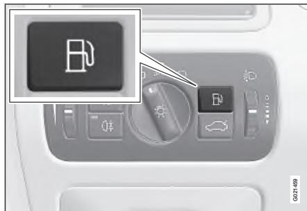
Чтобы открыть крышку, следует выключить двигатель. Откройте кнопкой на панели освещения. Крышка топливного бака расположена на правом заднем крыле, что указывается стрелкой на символе
