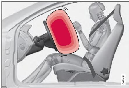
В дополнение к ремню безопасности автомобиль на стороне водителя оснащен надувной подушкой безопасности SRS (Supplemental Restraint System). Надувная подушка безопасности сложена в центральной части рулевого колеса. Такое рулевое колесо имеет маркировку **SRS AIRBAG**.
